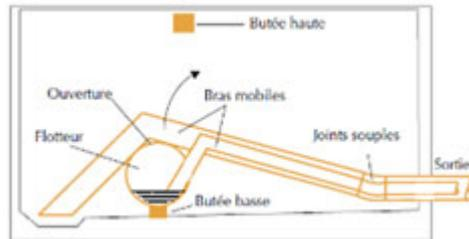
Fin de vaciado - Fuente : eau-barousse
