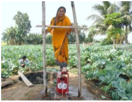
Pompe à pédales au Maharashtra (Inde).Photo Géo-IDEI
