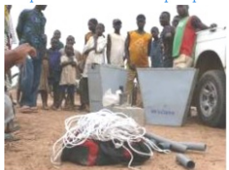
Corde et pistons, roue, structure supérieure, tubes et bloc de guidage
