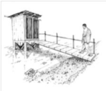
Un trou de défécation est aménagé dans le plancher surélevé. Il permet aux excréments :
