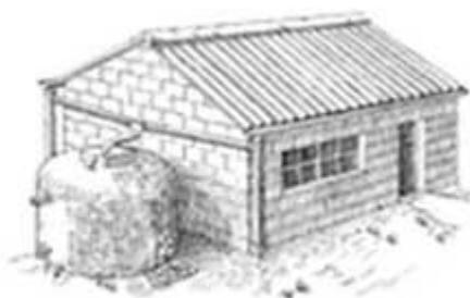
**La taille** réelle du système sera fonction de plusieurs facteurs : le coût, la quantité d'eau à collecter... **La toiture** doit être d'une superficie satisfaisante, en tôles non peintes, en tuiles ou en fibres de verre. Ensuite, la hauteur du toit doit être suffisante pour permettre à l'eau d'alimenter le **réservoir** par gravité.
