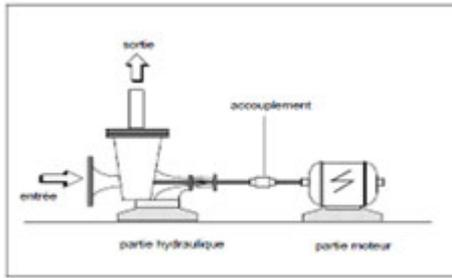
Bomba eléctrica centrífuga de superficie - Fuente : ACH
