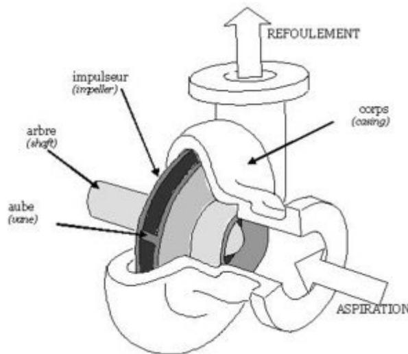
Esquema de una bomba motorizada centrífuga - Fuente : Wikipédia
