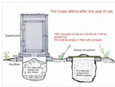
Esquema de funcionamiento de Fossa alterna
