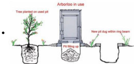
Esquema de funcionamiento de una letrina abonera de doble pozo (WEDC)
